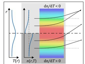
Für die Lasermaterialbearbeitung wie beispielsweise beim Schweißprozess werden Linsensysteme speziell für die benötigten Anwendungsfälle ausgelegt und konstruiert. Dabei spielen thermische Effekte eine nicht zu vernachlässigende Rolle. Durch die Laser-Bestrahlung entsteht innerhalb der Linse ein inhomogenes Temperaturfeld, welches einen maßgeblichen Einfluss auf den Strahlengang des Lasers hat. Unser Ziel ist es nun, die zwei einflussreichsten Effekte
